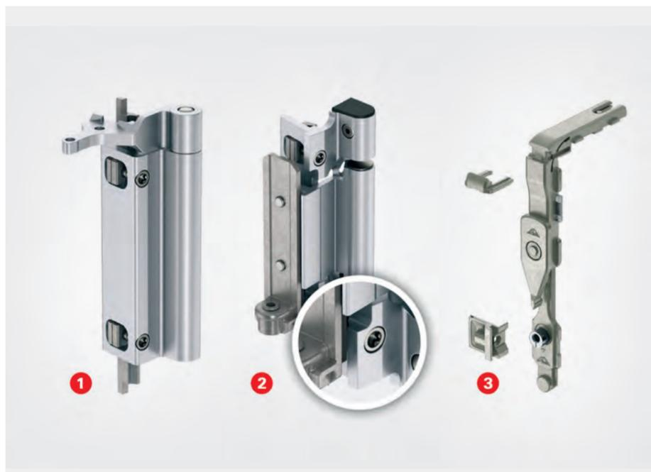
Serralheiros e arquitetos têm vantagens iguais com a nova geração de sistema de ferragens Roto AL. Apropriada para folhas com altura até 2.700 mm: o sistema de dobradiça do Roto AL (1). Para garantir montagens rápidas e seguras: acionamentos Torx integrados (2). Montagem econômica e sem ferramentas através de uma forquilha de encaixe para fixação da transmissão angular (3).
