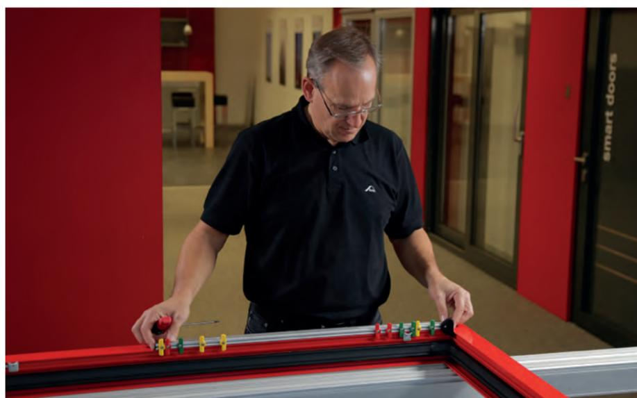
Para assegurar um cálculo simples e sem erros das posições do fecho, os braços padronizados T4 e T5 são instalados com as respectivas medidas fixas. Estas peças podem ser cortadas sob medida previamente, facilitando a pré-fabricação.
