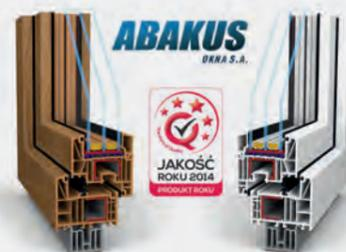
A Abakus bluENERGY em PVC com elevado isolamento térmico aposta em um sistema de vedação triplo com perfis de 6 câmaras e dispõe de profundidade de construção de 82 mm. A janela desenvolvida com base na norma de casa passiva foi premiada com o reconhecido selo de "Qualidade do Ano de 2014".
