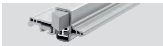
Junta anti-poeira, com isolamento térmico e acústico: A junta inferior Roto Eifel Texel convence pelo seu corpo de PVC de rápida absorção, câmaras ocas integradas, um perfil isolante de silicone e uma vedação escovante intermediária na barra central (não está na foto).
