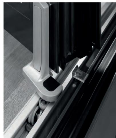
A direção precisa das roldanas é assegurada pelos deslizadores conduzidos pela lateral que têm rolamentos de esferas e são fabricados em material durável. Esta tecnologia proporciona a operação confortável, fácil e silenciosa inclusive de elementos de correr e sanfonados altos e pesados por muitos anos. Graças aos ajustes contínuos, a ferragem Roto Patio Fold é muito adaptável. Um ajuste de altura de +/- 3 mm é muito simples de executar com uma chave Allen.
