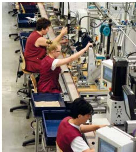
Na linha MON 81, na cidade húngara de Lövő, são fabricadas as roldanas e as tesouras deslizantes para o sistema paralelo e oscilo-paralelo Roto Patio Alversa. Os funcionários devem saber sobre cerca de 400 artigos de série na montagem e remessa. Para cada remessa são agrupadas cerca de 300 peças específicas para cada pedido.
