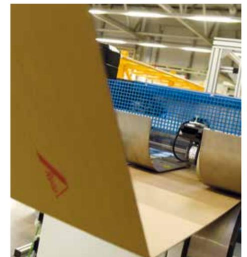
Em uma nova máquina de corte para caixas de papelão adquirida recentemente são fabricadas as embalagens sob medida para os 72 jogos de trilhos diversos. Elas embalam os trilhos de correr e mais 6 peças de um sistema de correr Roto Patio Alversa em diferentes comprimentos e cores.
