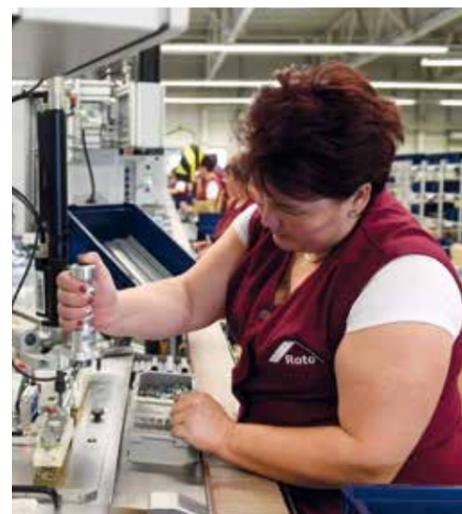
A linha de montagem trabalha com a tecnologia mais moderna de prensagem e aparafusamento para as mais diversas aplicações. Após a leitura do código do produto, a pressão da prensa é ajustada automaticamente. Na finalização, um sistema de medição do trajeto de prensagem verifica se uma agulha foi prensada como esperado.
